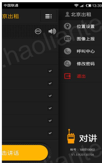
位置设置功能：点击 GPS 状态右侧“开启”处，弹出设置，可开启关闭位置上报。
